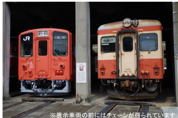
客車からディーゼルカーに改造された珍車キハ33(左)と 全国の勾配路線で活躍した汎用ディーゼルカーキハ52(右)
